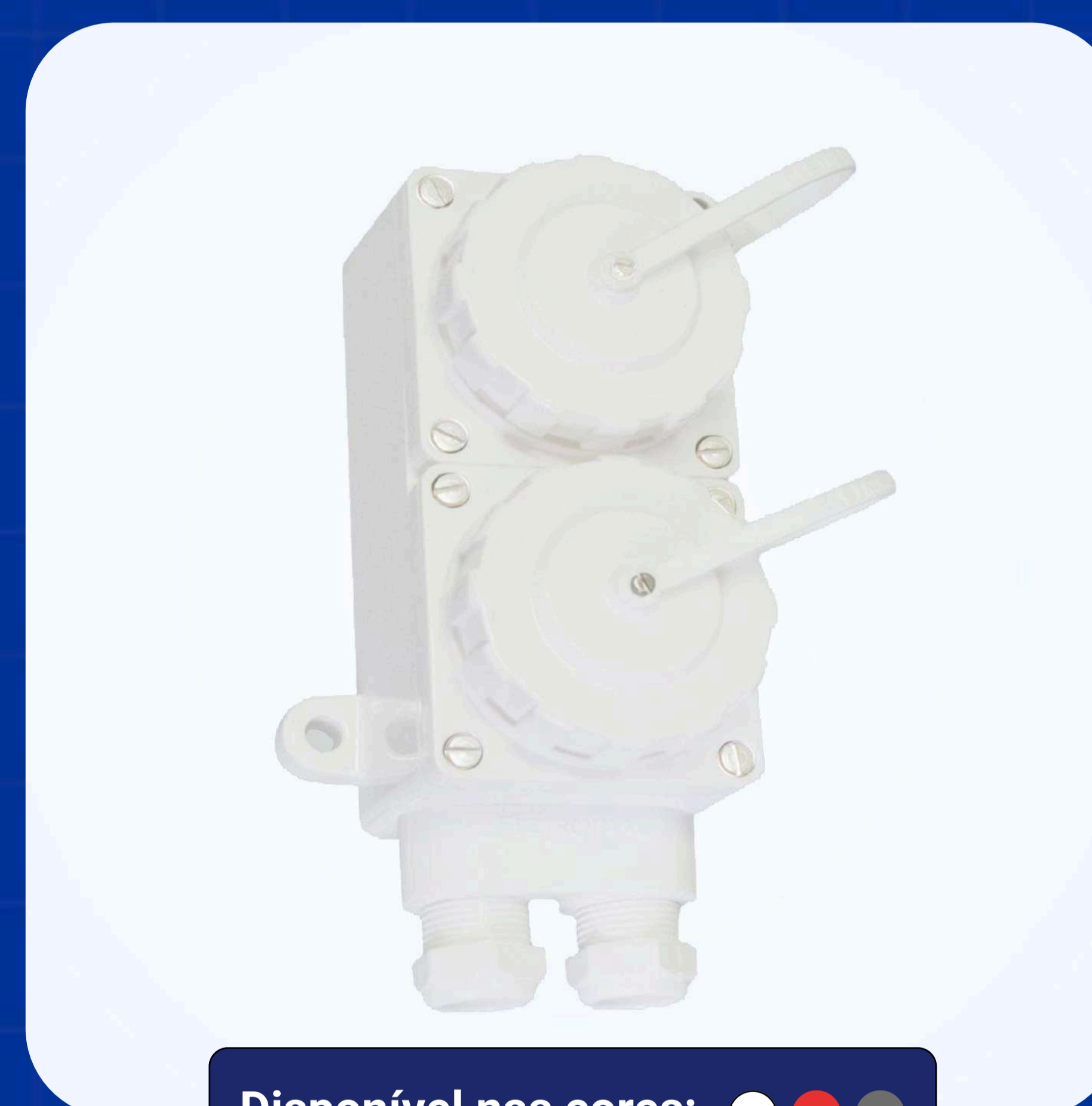
EN-104 - Tomada Dupla Estanque 2P + T (250V 10A) Padrão Brasileiro
