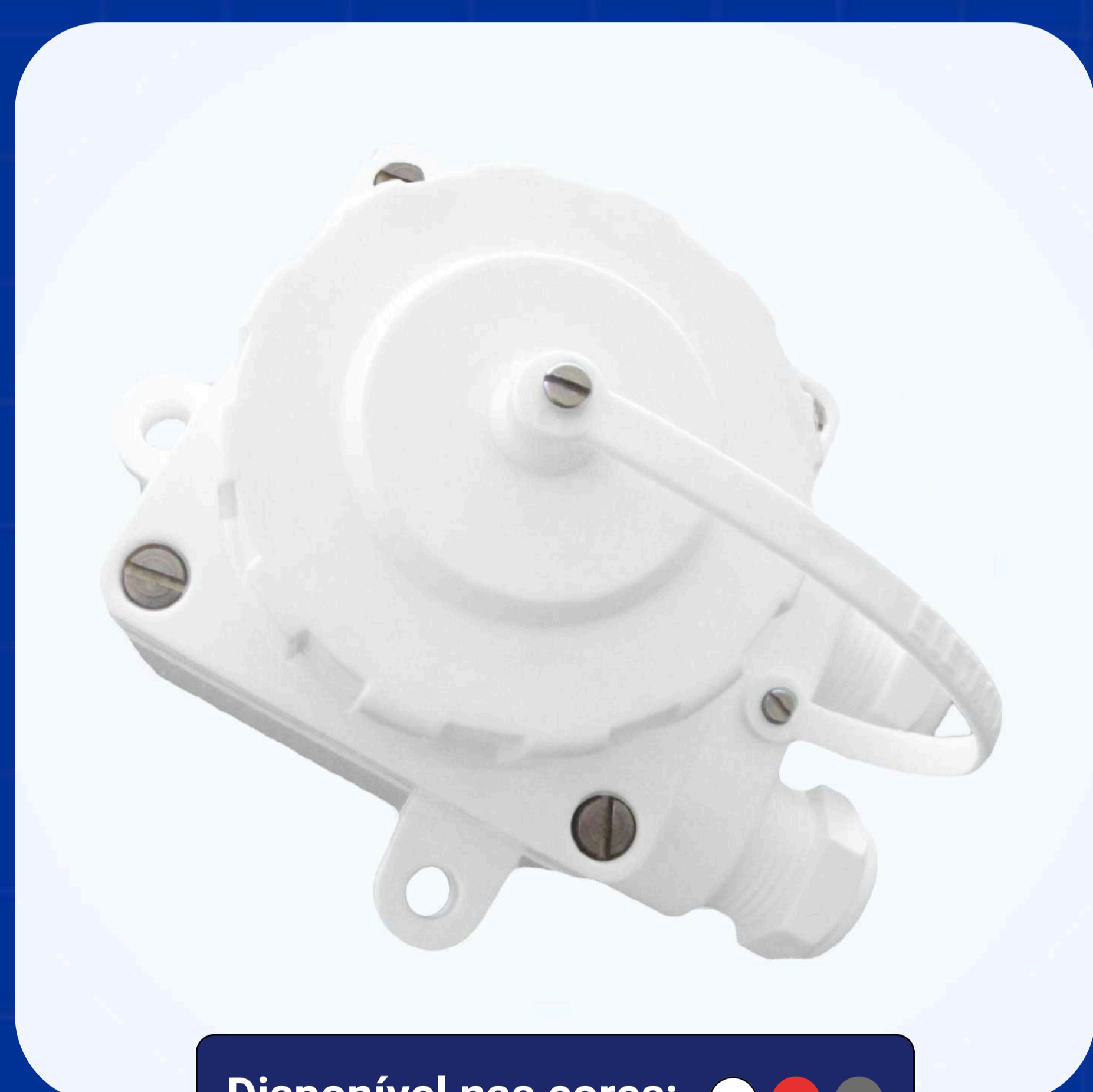
EN-101 (10A) - Tomada Estanque 2P + T (250V) Padrão Brasileiro
